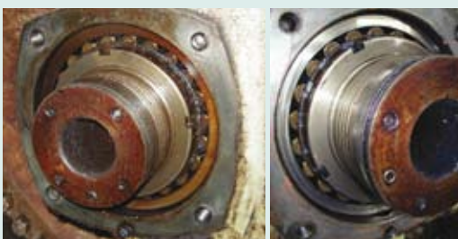
Palier de sécherie de machine à papier côté conducteur avant/après 8 mois de rinçage en service sans nettoyage mécanique.
