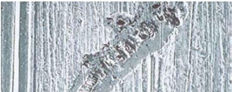
Intégration d'un copeau dans la surface d'un pallier lisse
