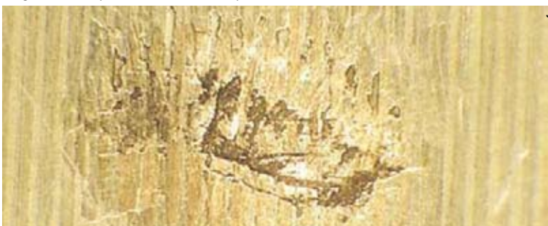
Détérioration d'une bande de roulement à billes par une contamination particulière
