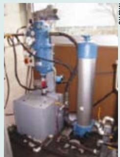
Filtre AF 173 sur bac de sédimentation avec filtre PI 230 et élément KS 25
